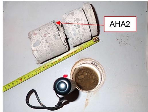
Kuvat 15 a ja b. Varaston 4 alapohjan rakennekerrokset avauksessa RA1. Bitumisivelyä otettiin materiaalinäyte PAH- ja asbestianalyysiin (AHA2: ei sisällä asbestia, PAH-pitoisuudet pieniä). Hiekkatäyttö on silmämääräisesti kostea.
