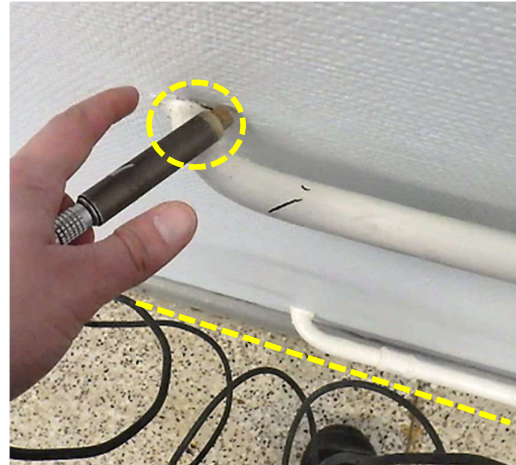
Kuvat 31 a ja b. Tarkekuvat kuvaan 28 merkkiainekokeen MA1 yhteydestä todetuista ilmavuotokohdista.
