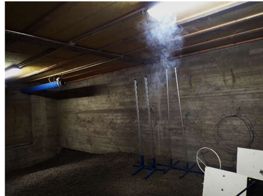
Kuvat 88 a ja b. Pohjakerroksen maapohjaisen ryömintätilan poistoilmanvaihto on toteutettu kanavapuhaltimella. Merkkisavun avulla havainnoituna tilan ilmanvaihto on puutteellinen, merkkisavun ei havaittu liikkuvan tehokkaasti puhaltimen suuntaan. Ilmanvaihtoa tapahtui lähinnä puhaltimen läheisyydessä.
