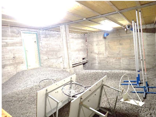
Kuvat 88 a ja b. Pohjakerroksen maapohjaisen ryömintätilan poistoilmanvaihto on toteutettu kanavapuhaltimella. Merkkisavun avulla havainnoituna tilan ilmanvaihto on puutteellinen, merkkisavun ei havaittu liikkuvan tehokkaasti puhaltimen suuntaan. Ilmanvaihtoa tapahtui lähinnä puhaltimen läheisyydessä.
