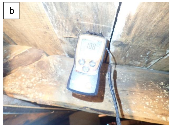
Kuvat 93 a...b. Yläpohjatilassa olevan viemärituuletusputken muhvi on iso lohkeama (kuva a) Yläpohjan puurakenteet todettiin pistokoeluontoisilla piikkimittauksilla kuiviksi (kuva b).
