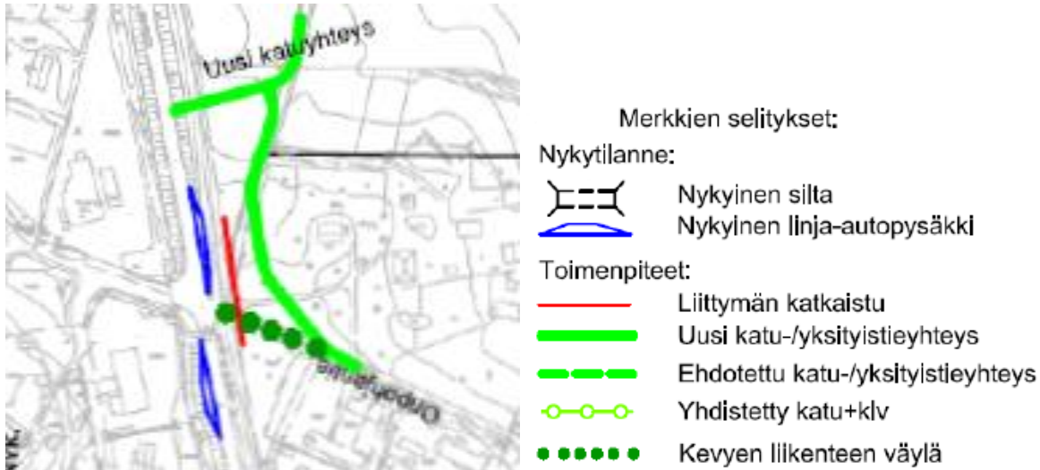
Kuva 3. Ote kantatien 58 tarveselvityksestä, kuvassa Oripohjantien ja kantatien liittymän katkaisu
