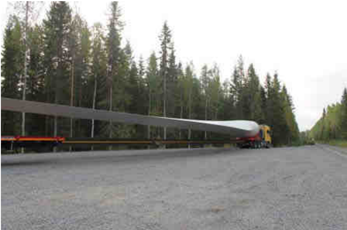
Kuva 7-11. Esimerkkikuva lavan kuljetuksesta, Savinevan tuulivoimapuisto (kuva: ABO Wind Oy).
