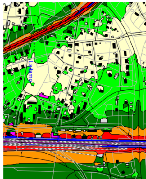
Kuva 15. Raideliikenteen (v. 2050) sekä tie ja katuliikenteen (v. 2040) yöajan klo 22-7 keskiäänitaso (LAeq) ennustetilanteessa. Lähde: Raideliikenteen meluselvitys, Orivesi (Ramboll, 2020)
