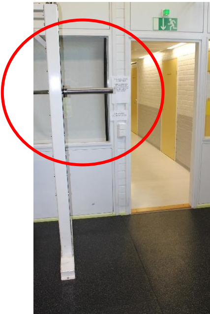
Kuva55. Pystypunnerruspaikan tanko aiheuttaa törmäysvaaran. Laitteiden väliin jää liian kapea kulkuväylä.
