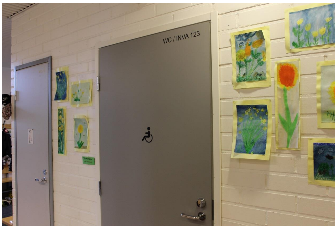
Kuva162. Opaste on sijoitettu suoraan oveen. Opaste tulisi sijoittaa oven avautumispuolelle seinään.
