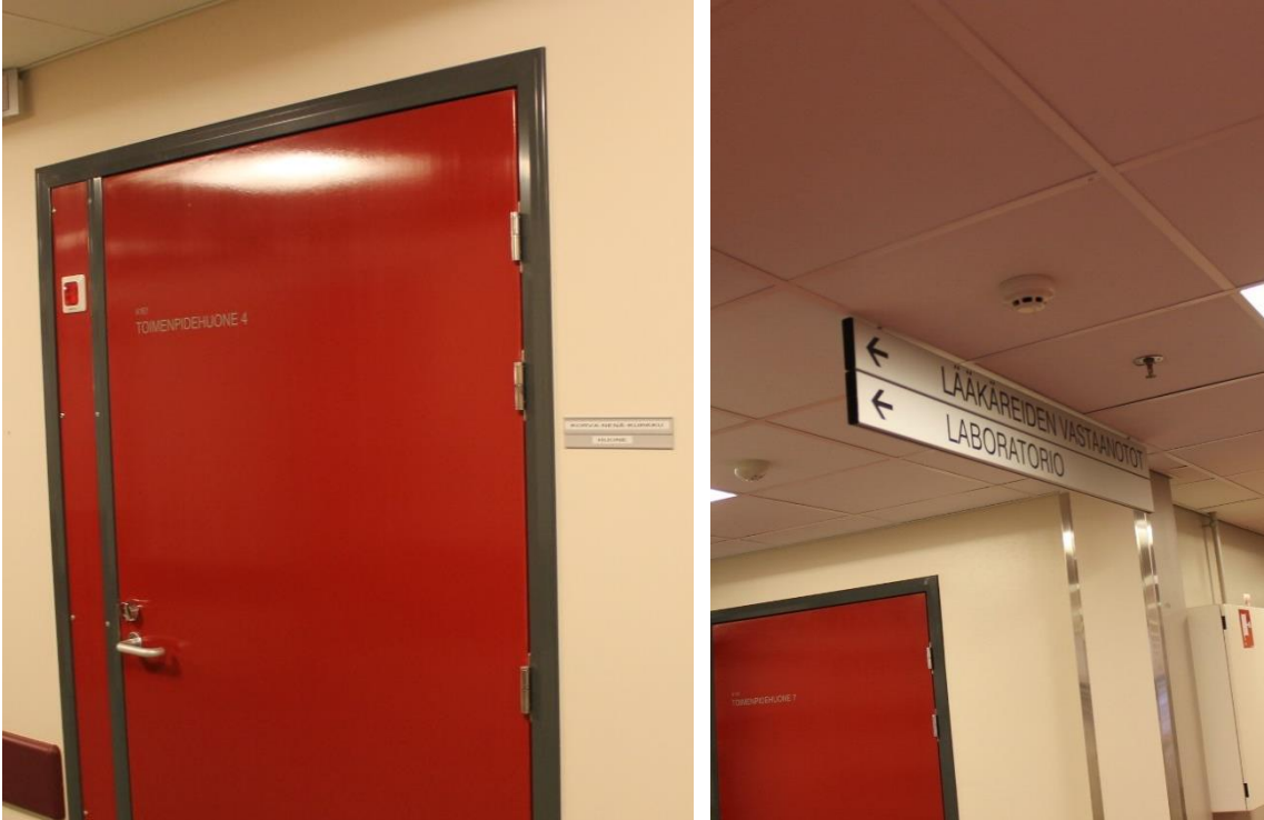
Kuva 26. Opaste sijoitettu oveen ja seinään oven sulkeutumispuolelle. Hyvä opasteen sijoituspaikka on oven avautumispuolelle seinään, jolloin opastetta pääsee lukemaan läheltä, eikä sen lukeminen aiheuta törmäysvaaraa (oveen sijoitettu opaste voi aiheuttaa). Opasteita on sijoitettu kulkuväylien yläpuolelle. Yläpuolelle sijoitettujen opasteiden lisäksi opasteita tulisi sijoittaa seiiniin noin silmän korkeudelle.
