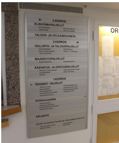
Kuva5. Pääaulan opasteita. Opastetulusta puuttuu merkinnän esteettömiä reiteistä. Lasin taakse sijoitettuihin opasteisiin muodostuu heijastusta.
