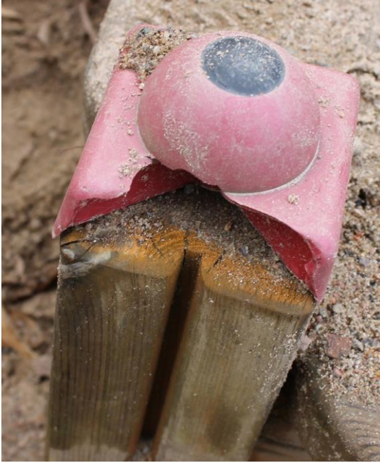
Kuva44. Muovisuoja on rikkoutunut. Keinulaudan puuosat ovat kuluneet ja niistä voi alkaa irrota tikkuja.
