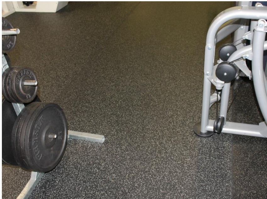
Kuva55. Pystypunnerruspaikan tanko aiheuttaa törmäysvaaran. Laitteiden väliin jää liian kapea kulkuväylä.
